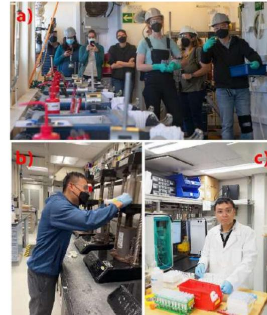
图 28 本人作为 IODP 397 航次的地球化学家：(a) 在甲板层对未切割岩芯进行取样；(b) 利用液压挤压装置获取孔隙水样品；(c) 对孔隙水样品进行上机测试前处理。
