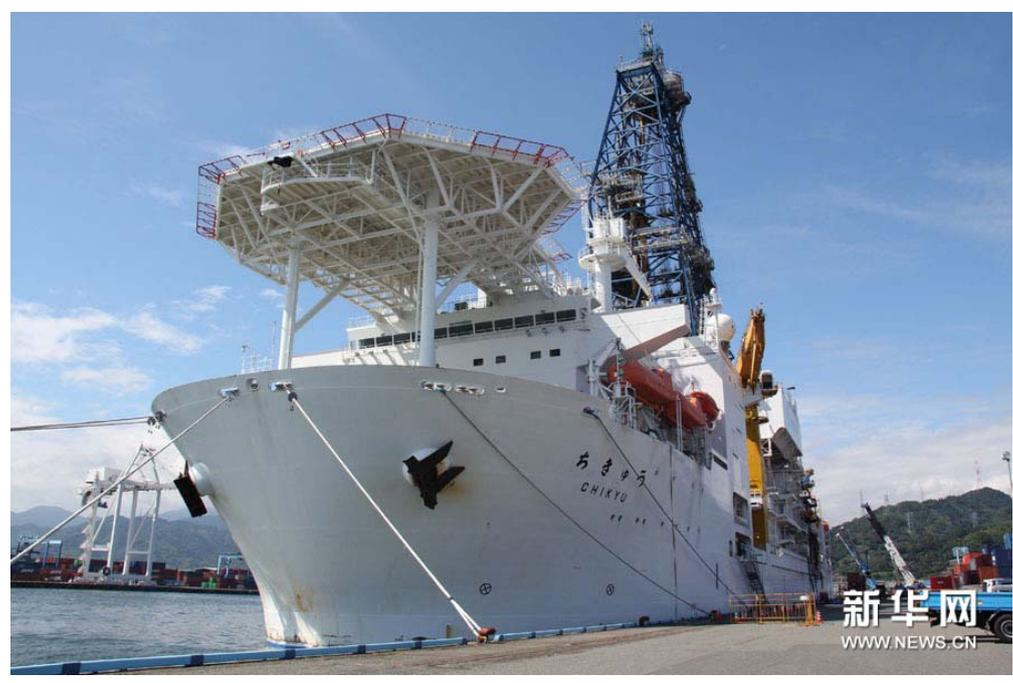
海洋研究开发机构经营企划部调查员长谷部喜八介绍说，“地球号”在水面上共有5层，水下3层，全长210米，宽38米，吃水9.2米，总吨位约5.7万吨，满载续航能力约1.48万海里，最大时速达到12节，中间用于钻探的高大井架高达130米（从船底计算），是世界最大级的钻探船之一，若限于带有实验室的钻探船，则是全球老大。
